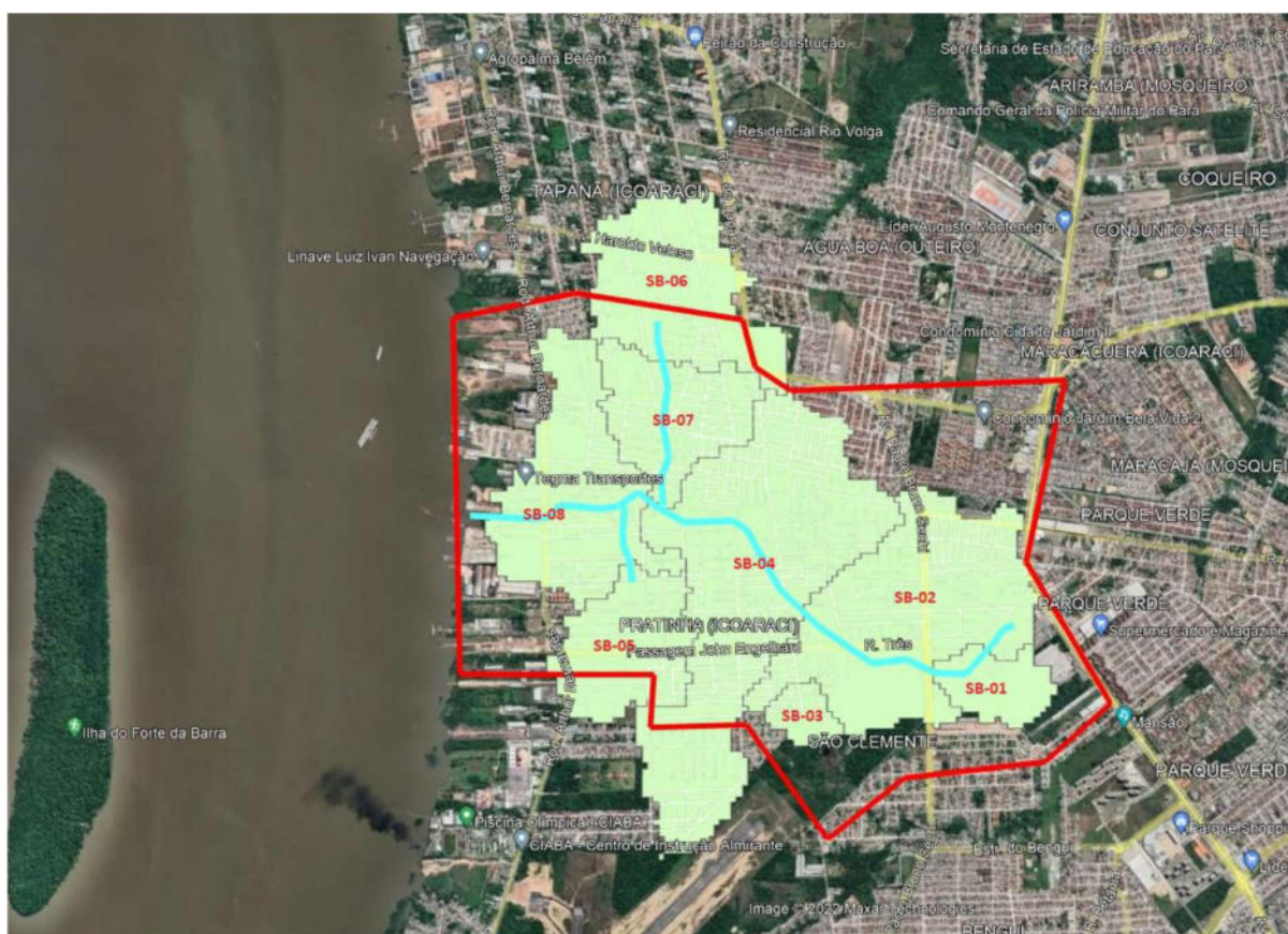
FIGURA 2 - ÁREA DA BACIA DE DRENAGEM DO MATA FOME OBTIDA POR POLIGONAÇÃO DIGITAL EM IMAGEM SRTM (FONTE: TPF/SOLUÇÃO, 2023)
