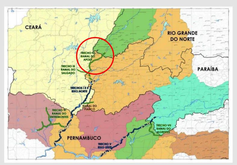
Tem como finalidade conduzir por gravidade a vazão de até 40 m³/s, em um percurso de cerca de 115 km a partir do Eixo Norte do Pisf (Barragem de Caiçara) até o Reservatório de Angicos, de onde segue no leito do Rio Apodi para abastecimento de outro importante reservatório do estado do Rio Grande do Norte, a Barragem de Santa Cruz.
