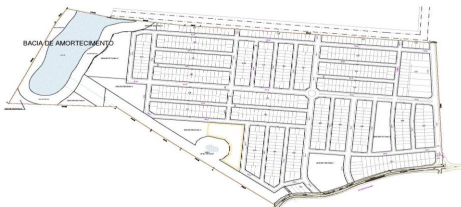
Figura 39 – Loteamento da empresa Frizzo – detalhe da bacia de amortecimento
