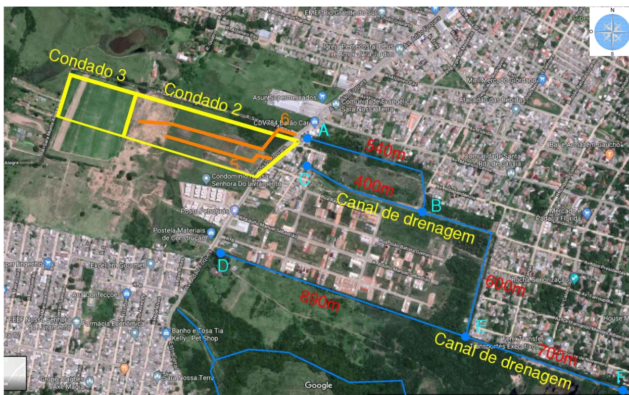
Figura 73 – Proposta escoamento Loteamento condados 2 e 3.
