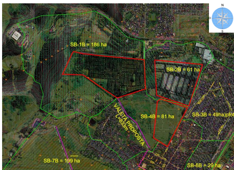
Figura 44 – Posição da valeta trapezoidal proposta – SB-4B e projetos de novos loteamentos demarcados em vermelho
