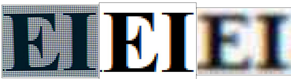
Figura 28 – Renderização de subpixel: à esquerda, a reprodução em monitor com aplicação de “renderização” de subpixel ; ao centro, a captura de tela do conteúdo à esquerda; à direita, a imagem do centro após processos de interpolação, inserção de ruído e compressão JPEG.
