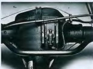
Sensor do ABS na carcaça do eixo traseiro
