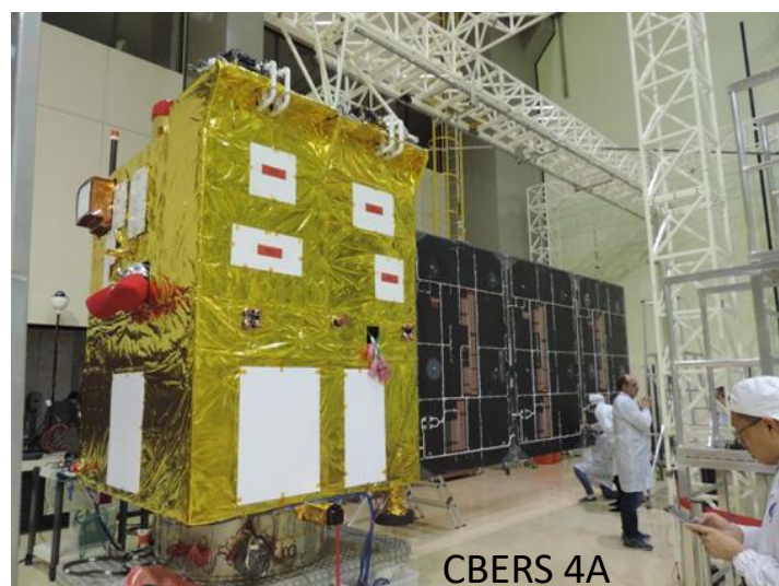
ENSAIOS DE ABERTURA DO PAINEL SOLAR
