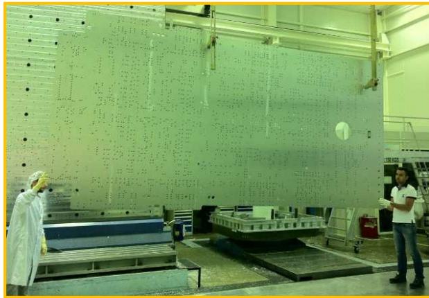
Instalação dos Insertos nos Painéis
