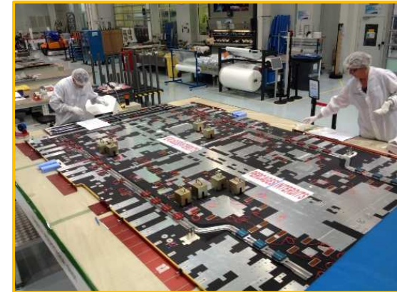
Colocação dos Heat Pipes no Módulo de Comunicação
