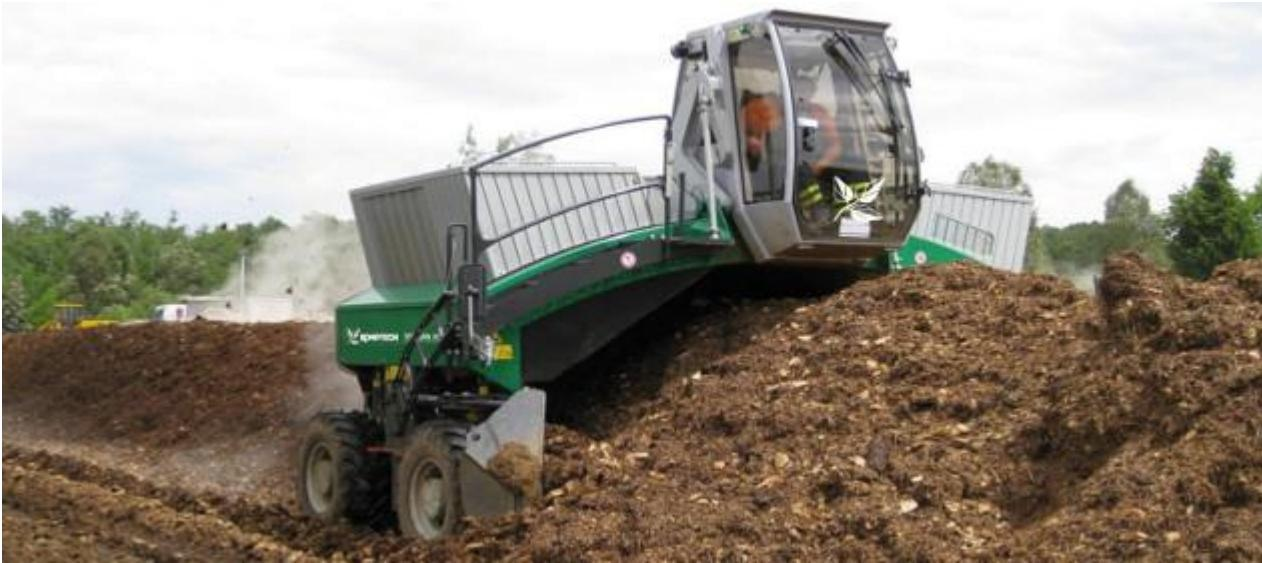
Equipamentos especiais para manipulação das pilhas de compostagem
