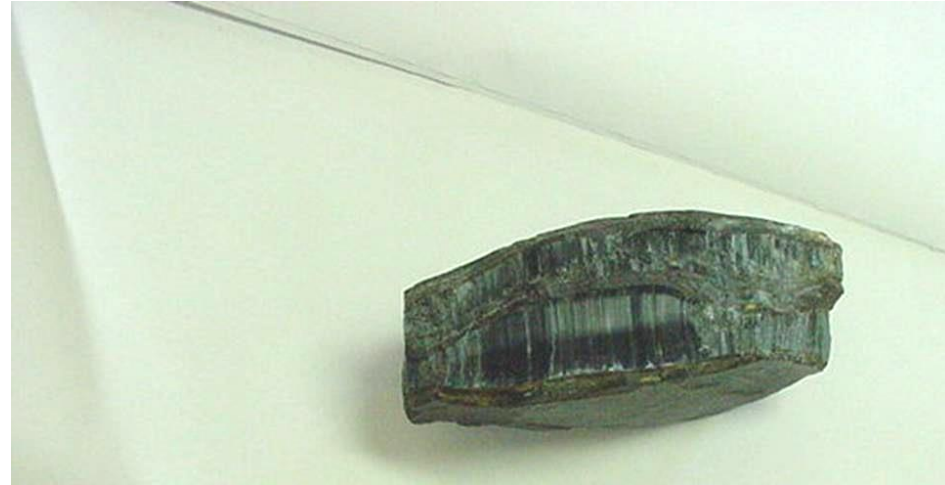
Asbesto Anfíbólio – Crocidolita Asbesto Azul - \text{Na}_2\text{OFe}_2\text{O}_3\text{FeOSiO}_2
