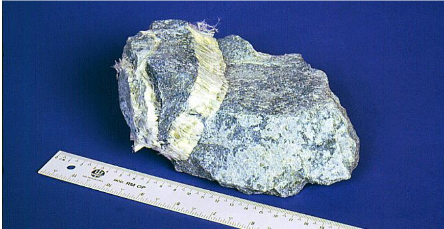
Asbesto Serpentinítico – Crisotila Asbesto Branco 3\text{MgOSiO}_2\text{H}_2\text{O}
