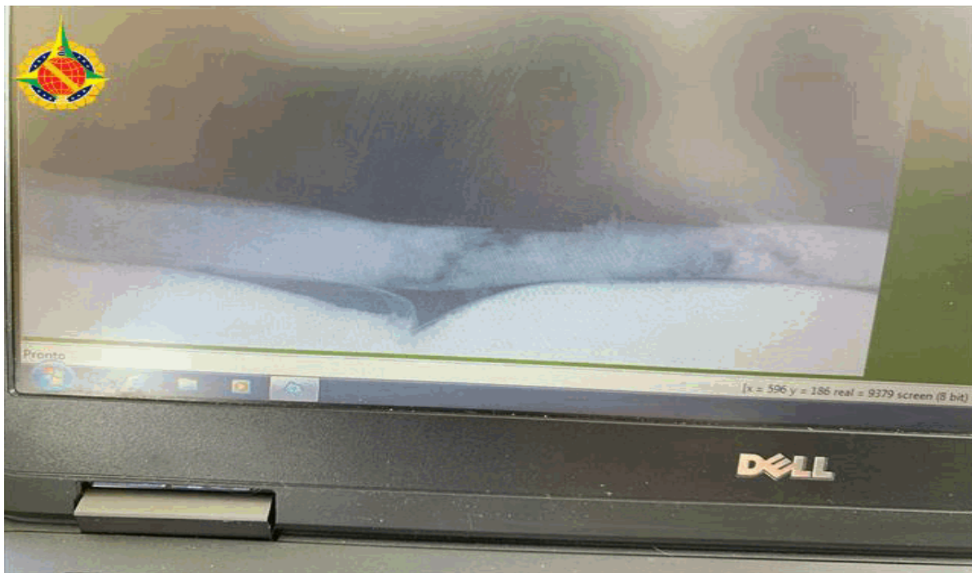
imagem do raio-x da massa explosiva após o uso do disruptor
