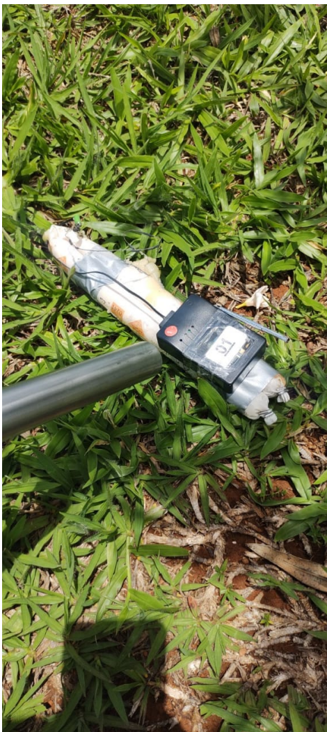
Figura 2 - Acionador pirotécnico elétrico conectado à emulsão explosiva
