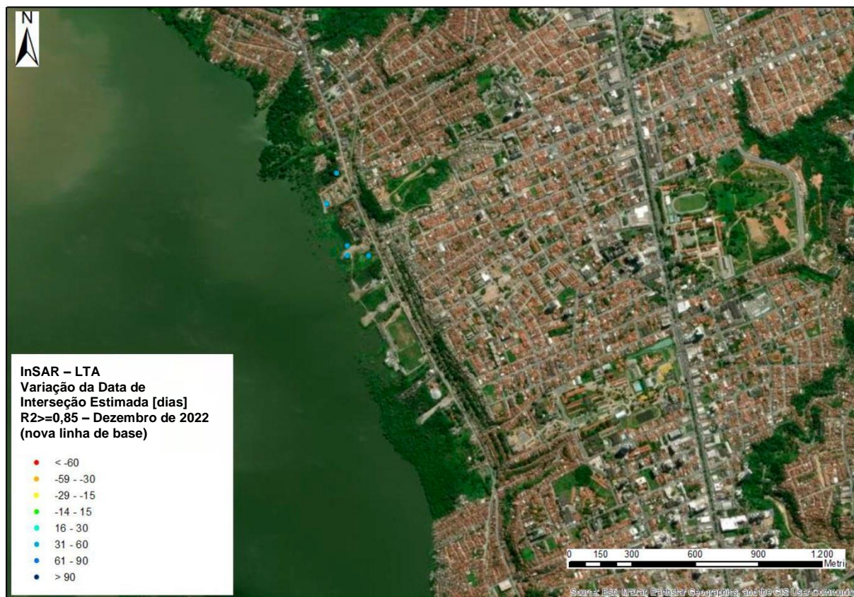
Figura 10. Variações das datas de interseção atualizando a LTA até os dados de InSAR de dezembro de 2022 para pontos com o parâmetro de ajuste linear da velocidade inversa R^2 acima de 0,85.
