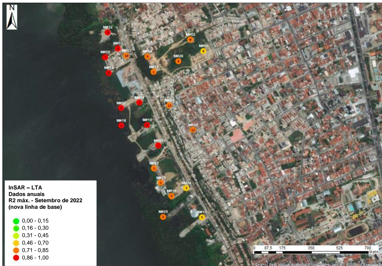
Figura 19. Relatório de setembro de 2022: valores máximos de R^2 de pontos dentro dos buffers IfG, análise de longo prazo; os números em preto indicam o número de pontos de InSAR dentro de cada buffer.
