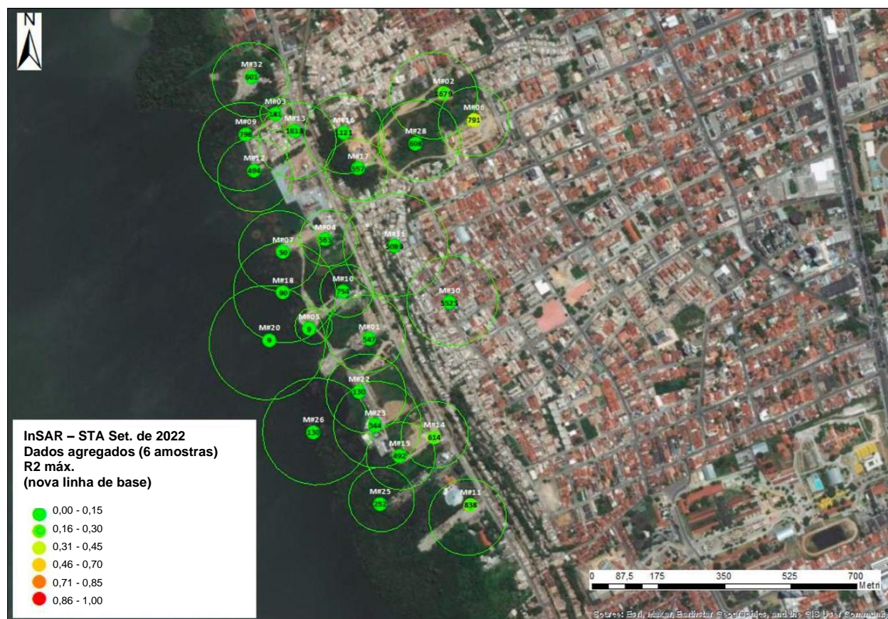
Figura 33. Relatório de setembro de 2022: valores máximos de R^2 de pontos ascendentes de InSAR na Análise de Curto Prazo.
