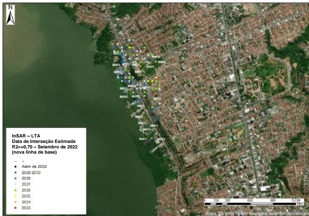
Figura 9. Relatório de setembro de 2022: Datas de interseção da análise da velocidade inversa para a LTA para pontos com R^2 acima de 0,70.
