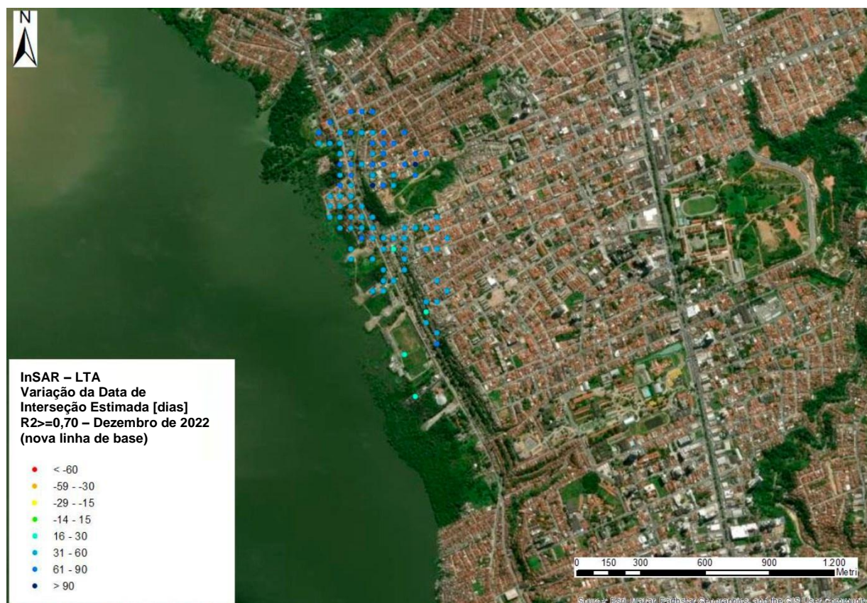
Figura 11. Variações das datas de interseção atualizando a LTA até os dados de InSAR de dezembro de 2022 para pontos com o parâmetro de ajuste linear da velocidade inversa R^2 acima de 0,70.
