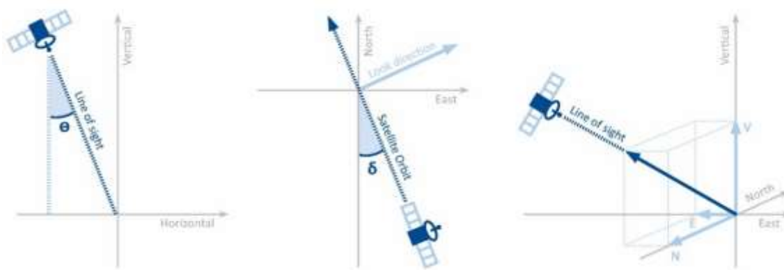
Figura 5: Geometria das aquisições das imagens em geometria ascendente.
