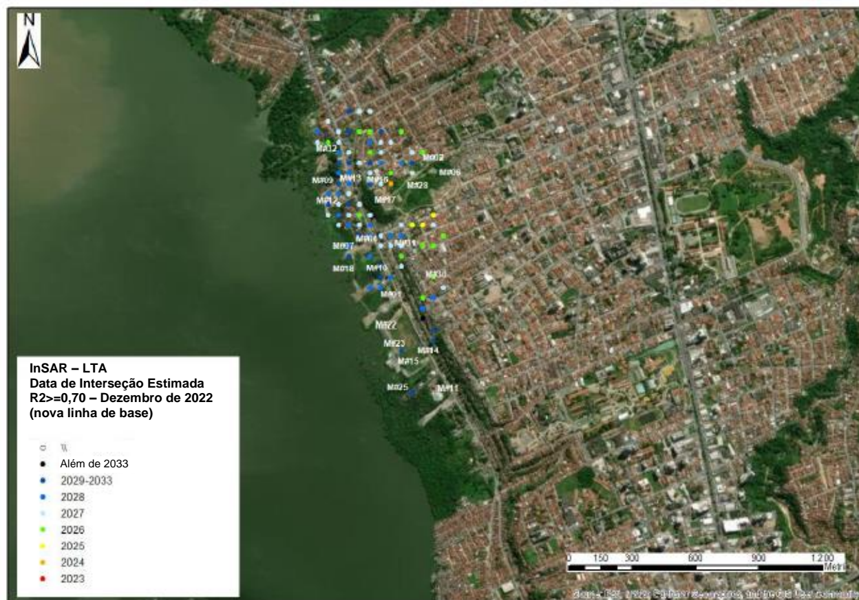
Figura 8. Relatório de dezembro de 2022: Datas de interseção da análise da velocidade inversa para a LTA para pontos com R^2 acima de 0,70.
