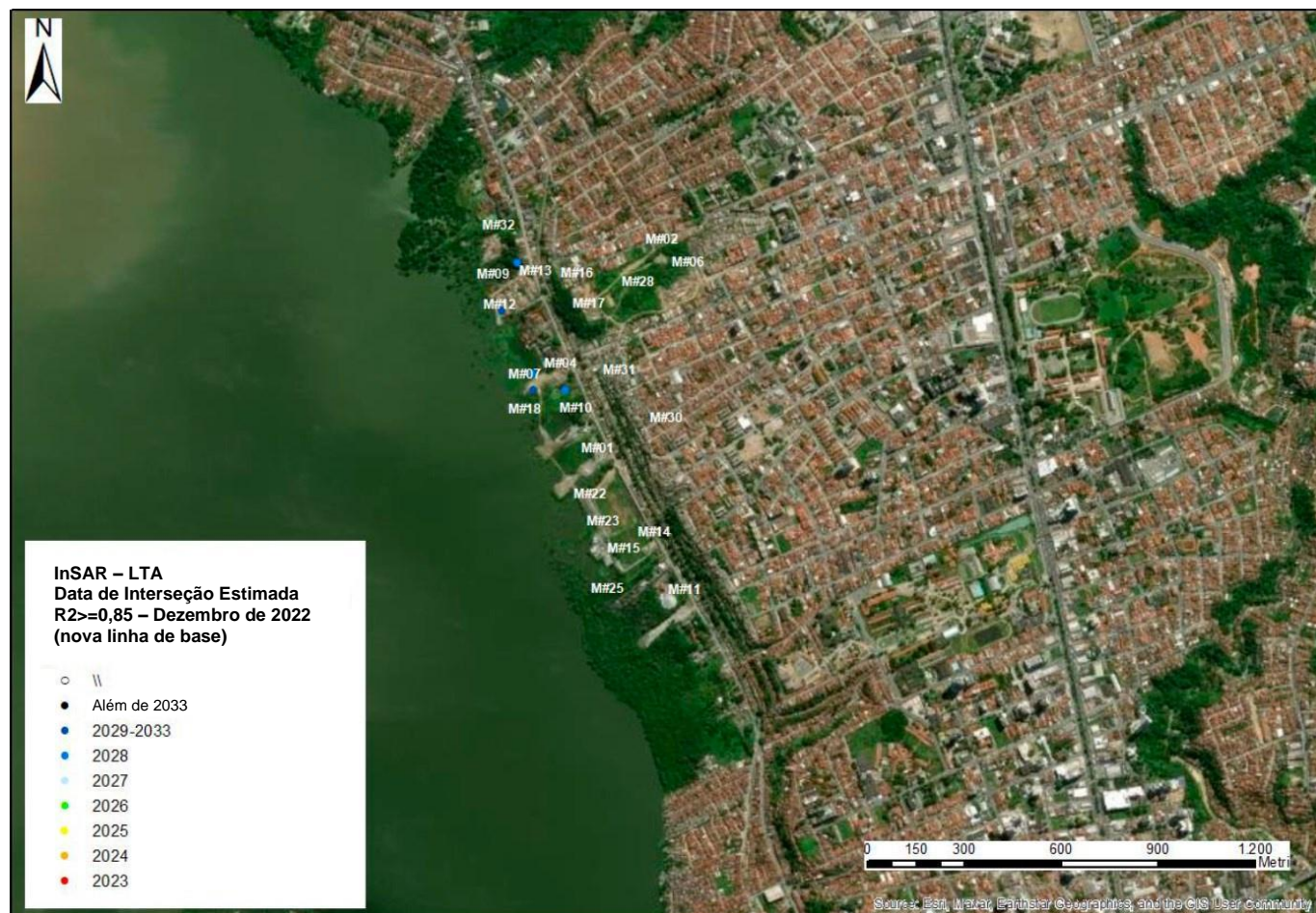
Figura 6. Relatório de dezembro de 2022: Datas de interseção da análise da velocidade inversa para a LTA para pontos com R^2 acima de 0,85.
