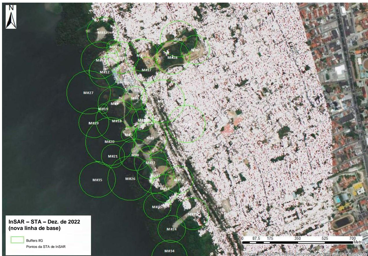
Figura 30. Dezembro de 2022: Pontos da STA em cinza, buffers circulares IfG em verde.
