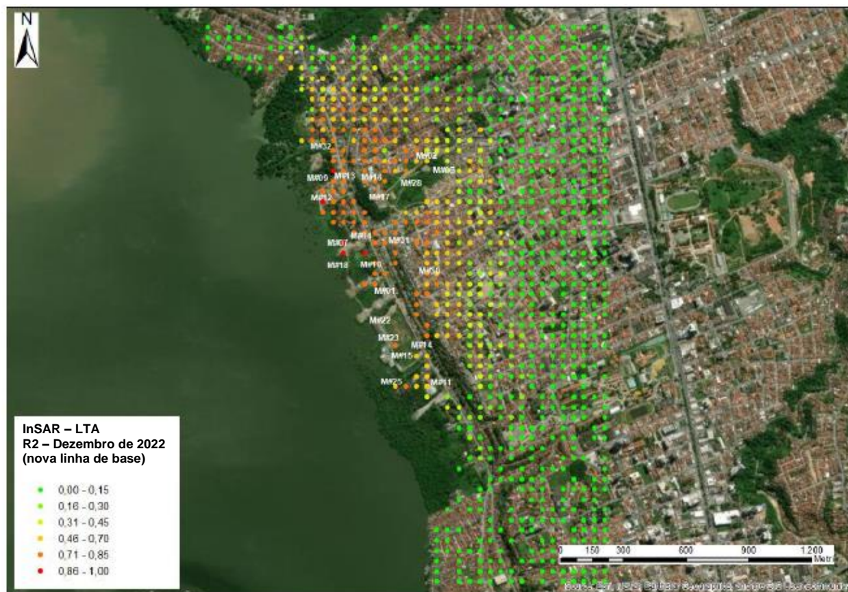
Figura 4. Valores R^2 de pontos com dados de InSAR para o período de 2007 - dezembro de 2022 na Análise de Longo Prazo.
