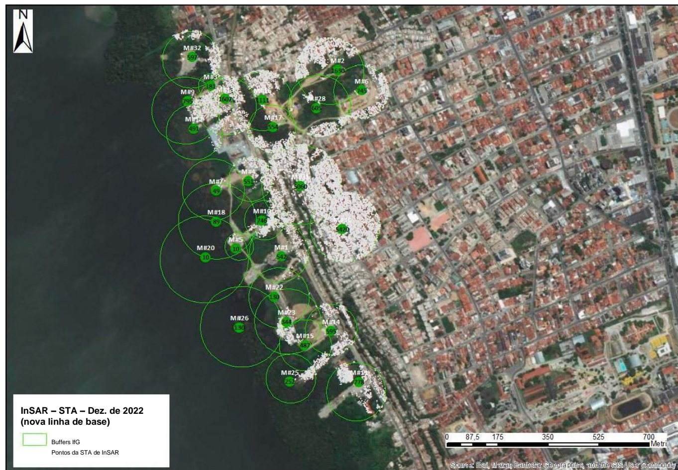
Figura 31. Buffers circulares IfG não vazios em verde, pontos dentro dos buffers em cinza, o número de pontos dentro de cada buffer em preto.
