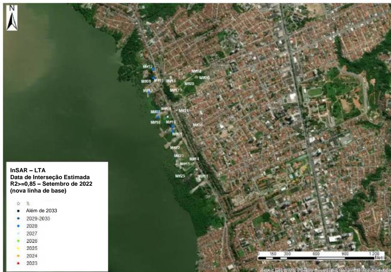
Figura 7. Relatório de setembro de 2022: Datas de interseção da análise da velocidade inversa para a LTA para pontos com R^2 acima de 0,85.
