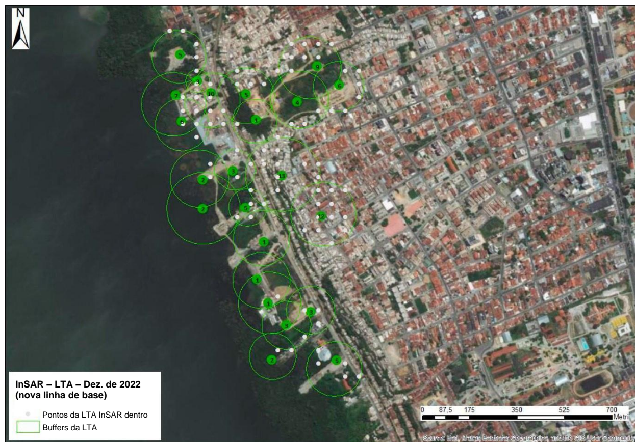
Figura 17. Buffers circulares IfG não vazios em verde, pontos dentro dos buffers em cinza, o número de pontos dentro de cada buffer em preto.
