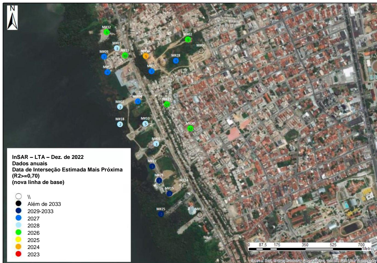
Figura 20. Atualização de dezembro de 2022: datas de interseção mais próximas ( R^2 \geq 0,70 ) da análise da velocidade inversa para a LTA; os números em preto indicam o número de pontos dentro de cada buffer.
