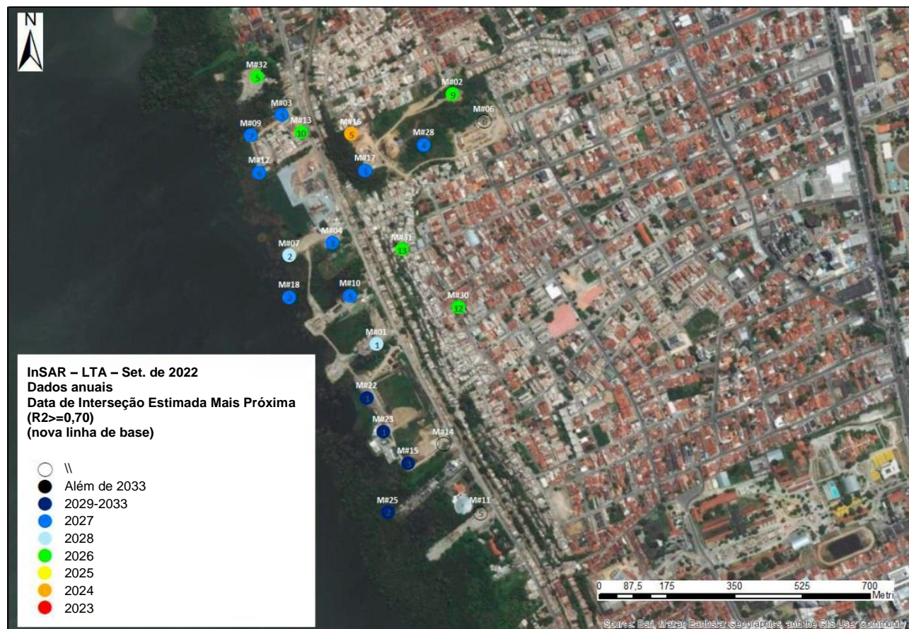
Figura 21. Relatório de setembro de 2022: datas de interseção mais próximas ( R^2 \geq 0,70 ) da análise da velocidade inversa para a LTA; os números em preto indicam o número de pontos dentro de cada buffer.
