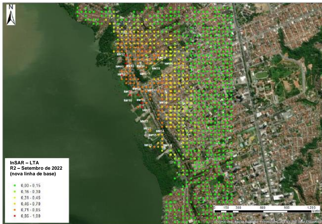
Figura 5. Valores R^2 de pontos com dados de InSAR para o período de 2007 - setembro de 2022 na Análise de Longo Prazo.
