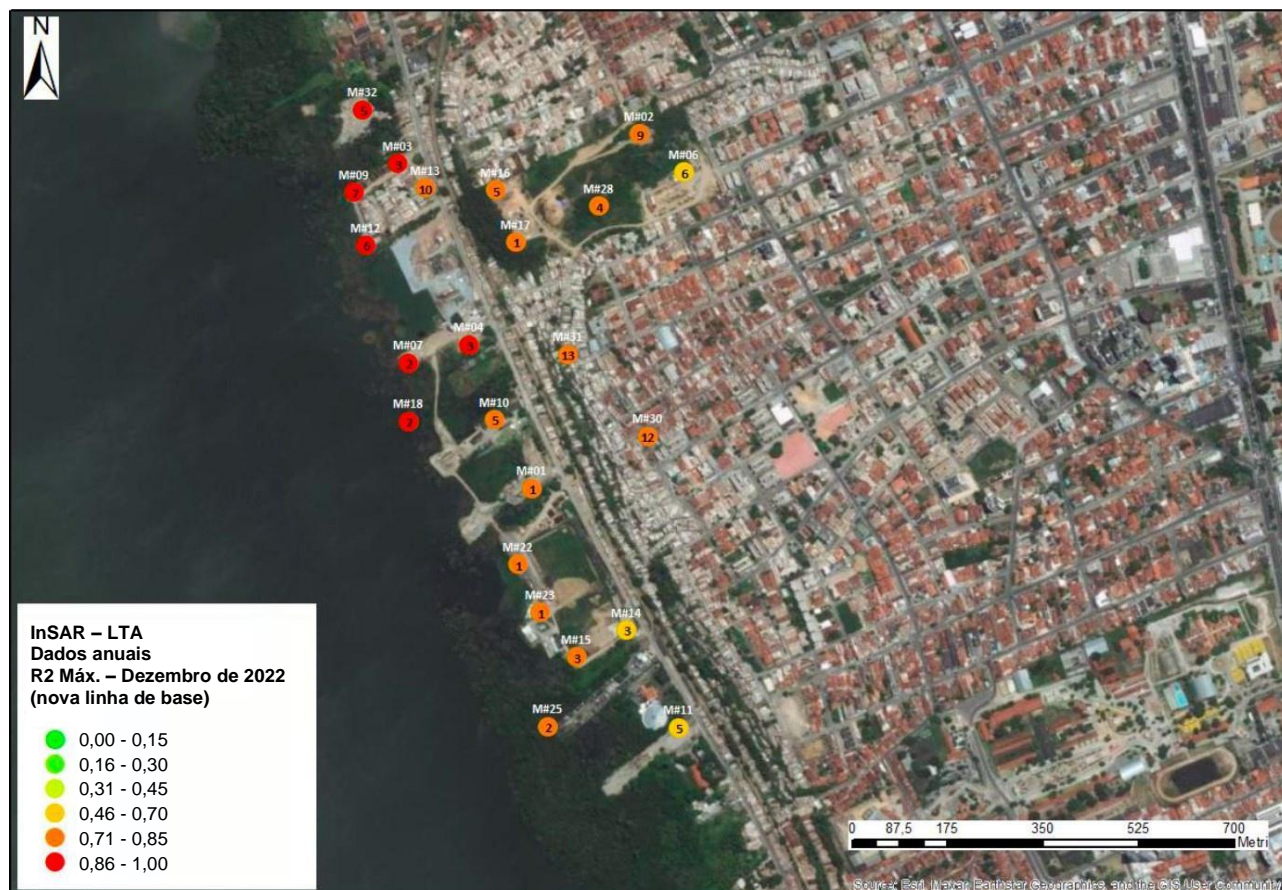
Figura 18. Atualização de dezembro de 2022: valores máximos de R^2 de pontos dentro dos buffers IfG, análise de longo prazo; os números em preto indicam o número de pontos de InSAR dentro de cada buffer.
