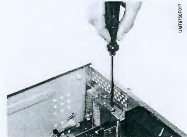
Figura 21 - Fixando a placa de expansão
