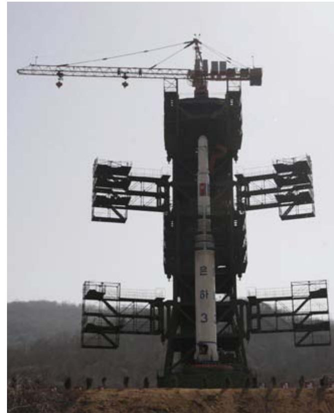
Foguete Unha-3 na plataforma de lançamento em abril de 2012. A carga-útil era um satélite de 100 kg, que se desintegrou junto com o foguete. No entanto, em 12 de dezembro do mesmo ano os norte coreanos colocaram o seu satélite em órbita.
