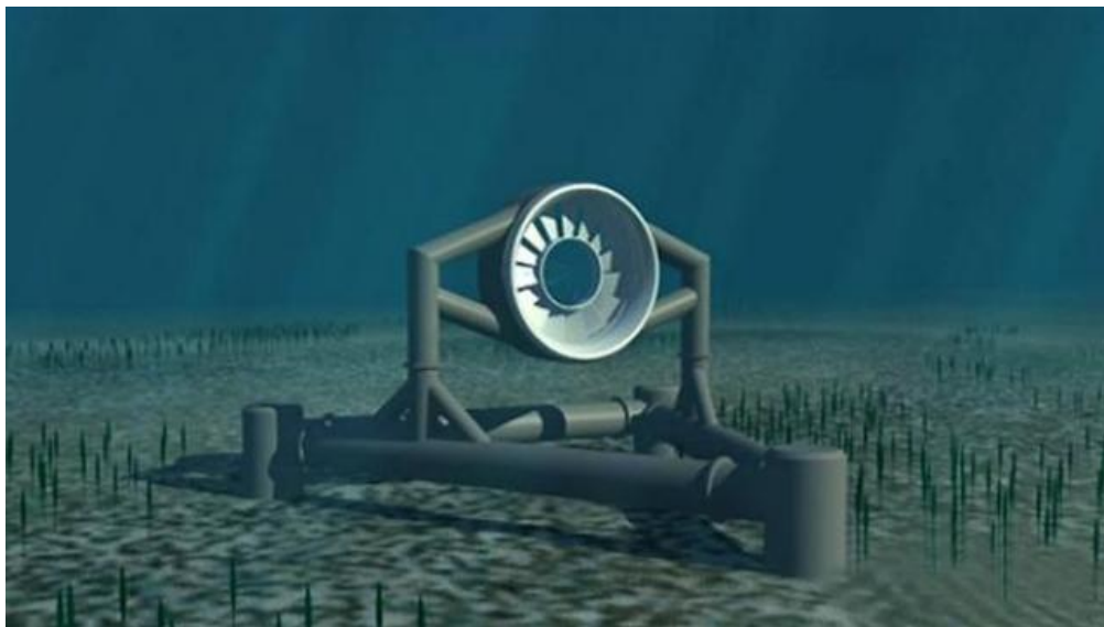
Figura 16 Exemplo de equipamento fixo ao fundo de geração de eletricidade a partir das correntes marinhas
