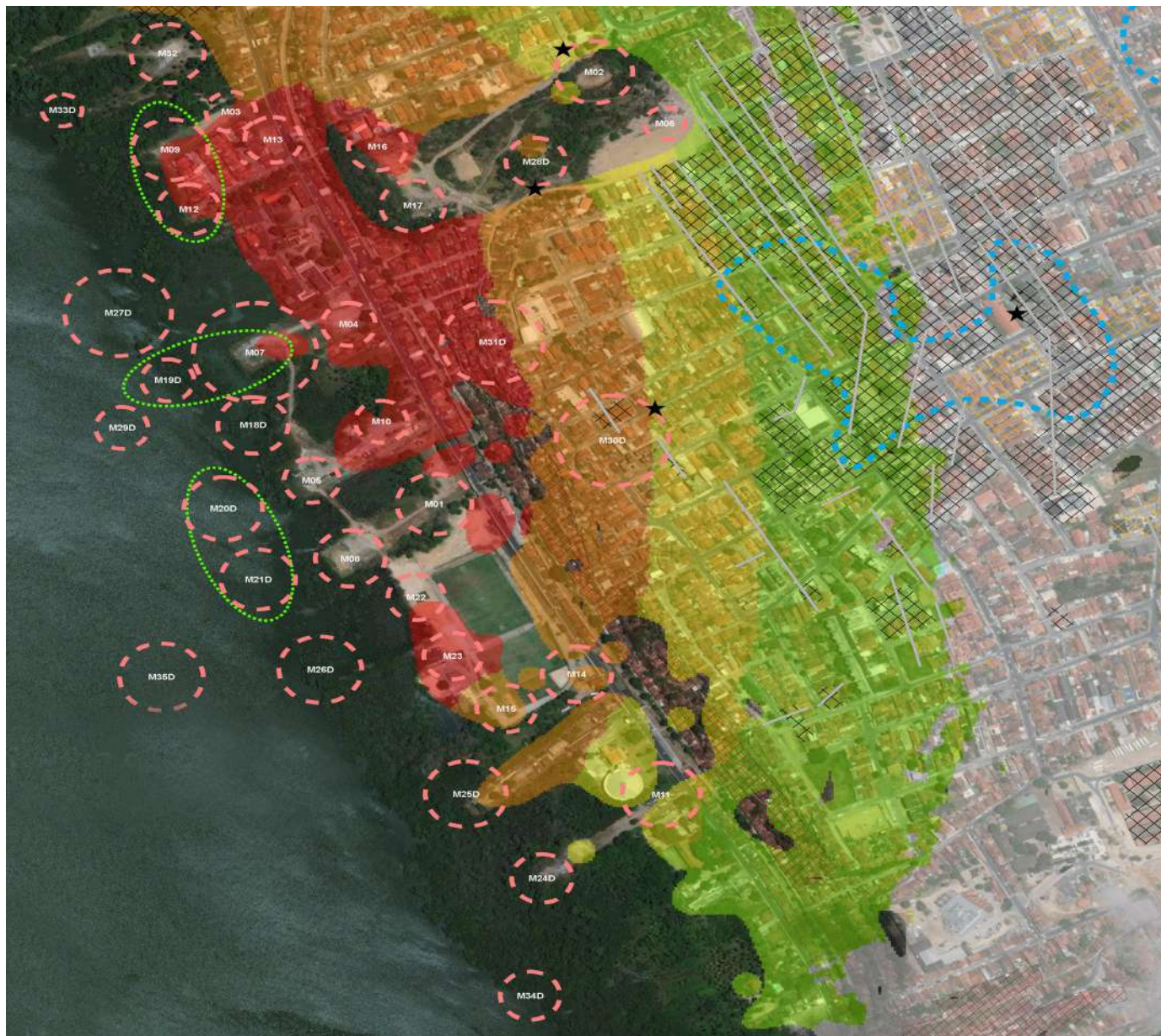
FIGURA 2 - RESULTADO DA INTERFEROMETRIA MOSTRANDO A POSIÇÃO DAS MINAS DE SAL (CÍRCULOS TRACEJADOS VERMELHOS) E DE MICROTERREMOTOS (ESTRELAS PRETAS)
