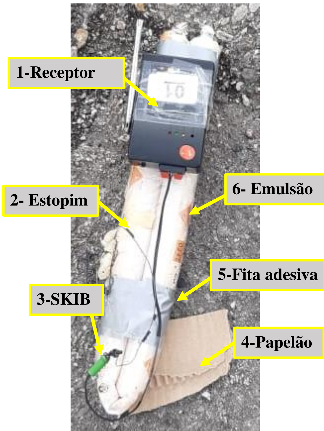
Fotografia 3 – Imagem do artefato antes da neutralização. Legenda indica: 1 – Receptor eletrônico; 2 – Feio do estopim tipo mantitor; 3 – SKIB, região da carga inflamável; 4 – Fragmento de papelão da caixa de papelão; 5 – Fita adesiva do tipo Silver Tape ; 6 – Emulsão explosiva encartuchada.
