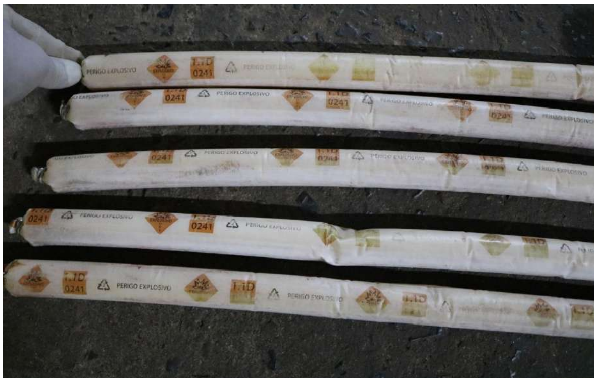
Fotografia 125 – Emulsões explosivas encontradas no interior do veículo examinado no Local 3.
