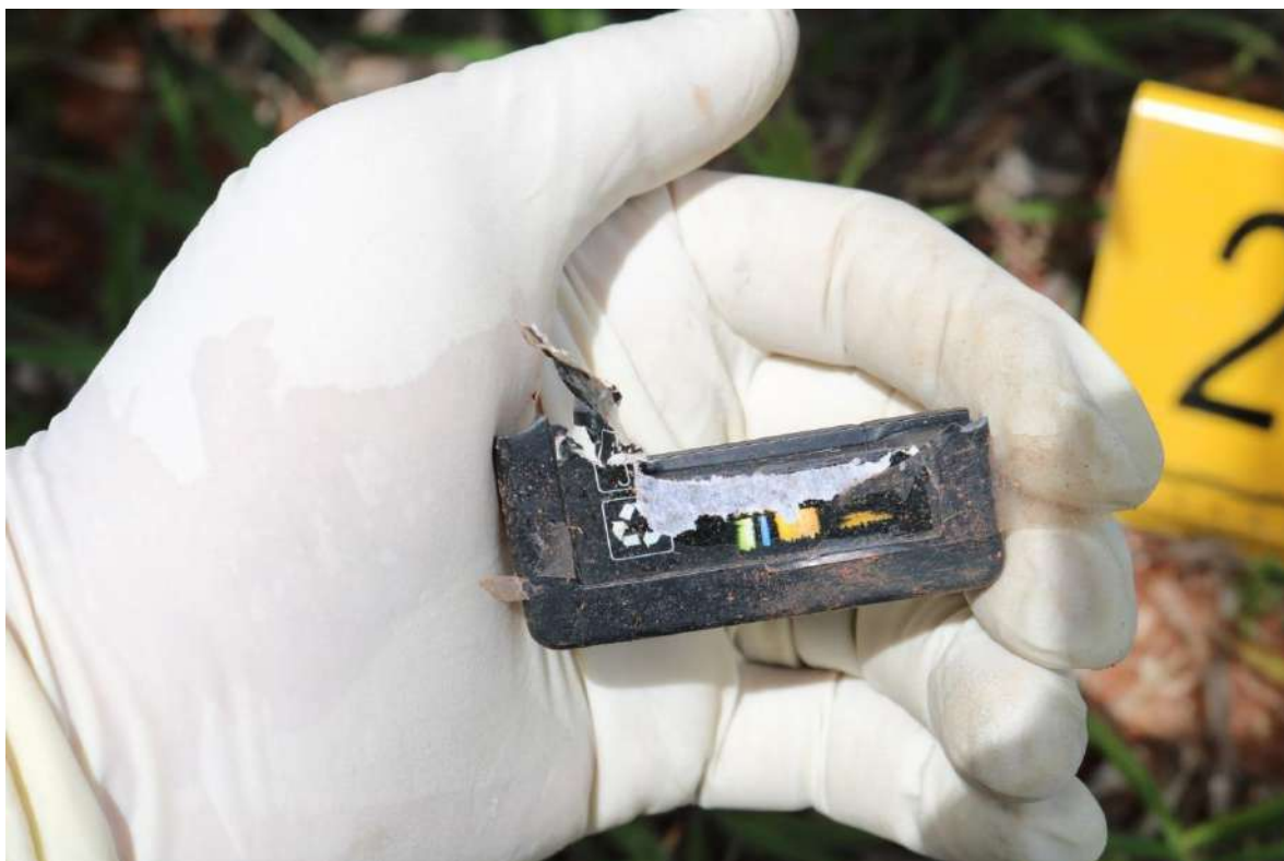
Fotografia 55 – Fragmento de material plástico de cor preta compatível com compartimento de pilhas.
