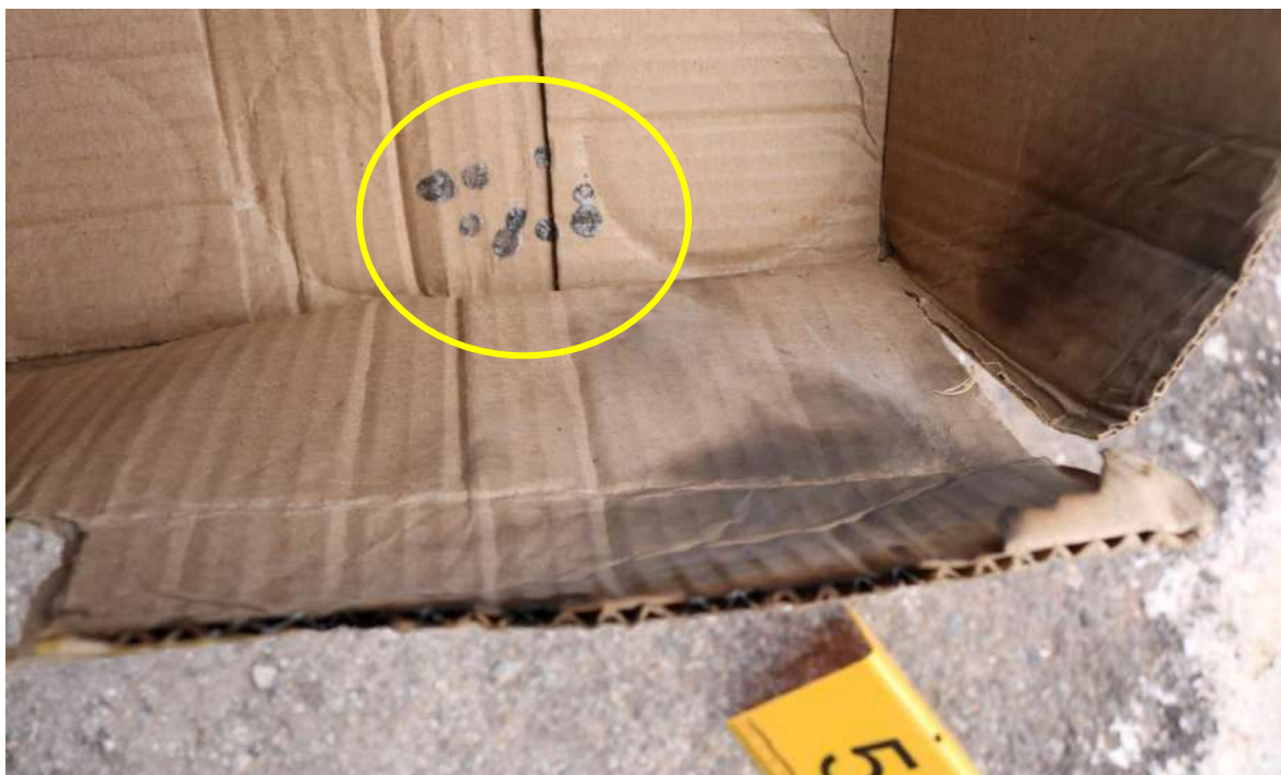
Fotografia 79 – Interior da caixa de papelão. Note marcas de queima e aderência de fuligem. Em destaque, resquícios de plástico comburido compatível com revestimento plástico do estopim quando comburido.
