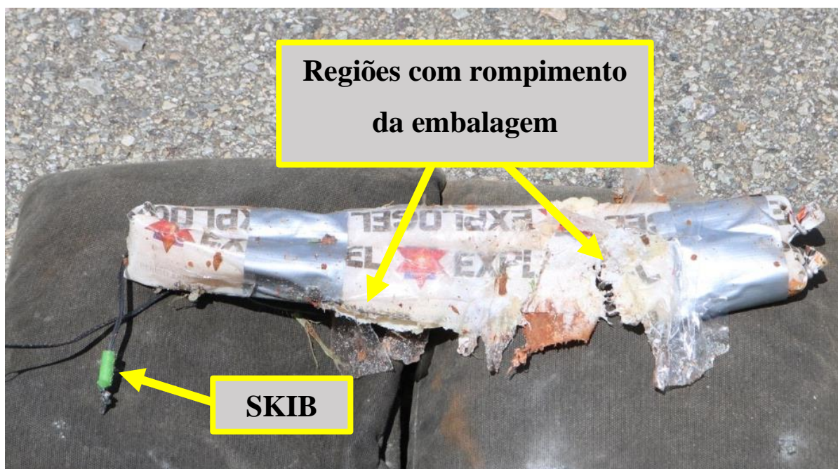
Fotografia 9 – Massa explosiva do artefato após neutralização.
