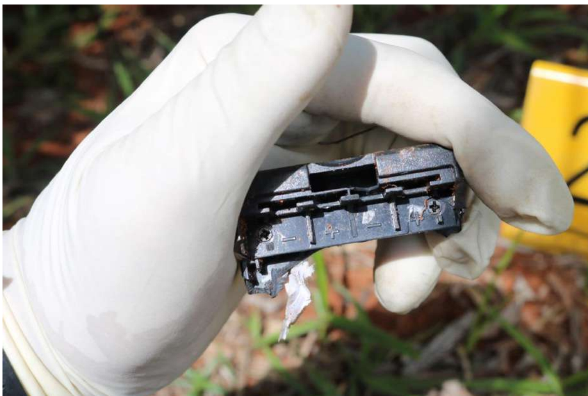
Fotografia 54 – Fragmento de material plástico de cor preta compatível com compartimento de pilhas.
