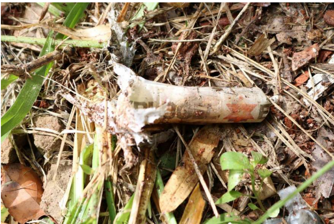
Fotografia 152 – Testes de campo. Parte da massa da emulsão explosiva (Local 3) que sofreu baixa ordem após acionamento.
