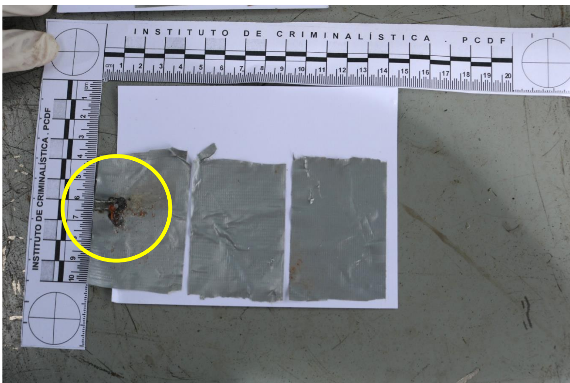
Fotografia 13 – Segmentos de fita adesiva do tipo Silver Tape . Em destaque, marcas de queima.
