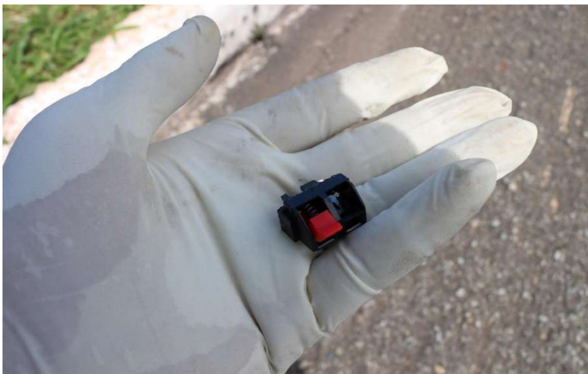
Fotografia 68 – Fragmento de material plástico, compatível com saída elétrica de componentes eletro/eletrônicos, em detalhe.
