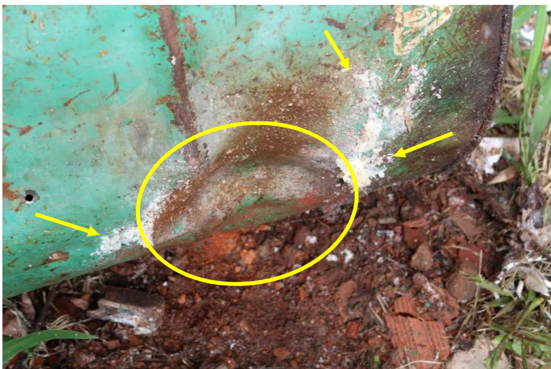
Fotografia 150 – Testes de campo. Região de pós explosão de uma das emulsões explosivas encartuchadas examinadas no Local 3. Em destaque região de amassamento no latão. Setas apontam espargimento da emulsão em baixa ordem.
