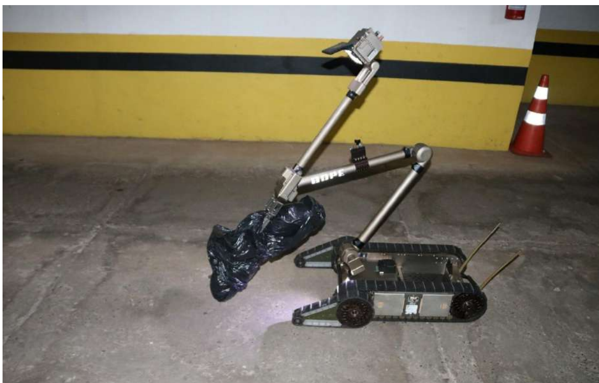
Fotografia 117 – Unidade robótica do Esquadrão de Bombas da PMDF, com emulsões explosivas presas à garra.
