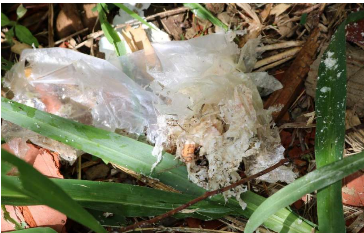
Fotografia 149 – Testes de campo. Restante da emulsão explosiva que sofreu baixa ordem após acionamento.
