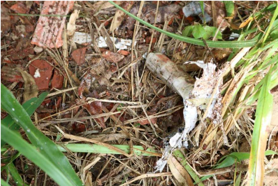
Fotografia 153 – Testes de campo. Parte da massa da emulsão explosiva (Local 3) que sofreu baixa ordem após acionamento.
