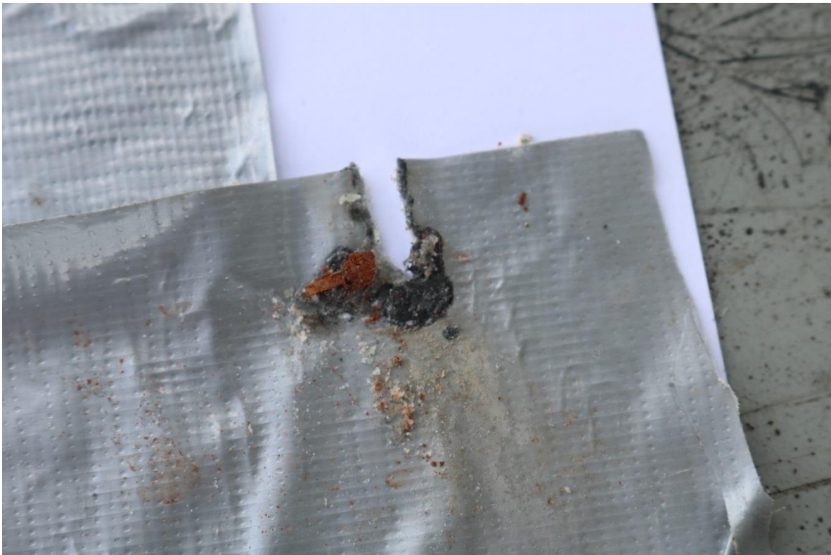
Fotografia 15 – Segmentos de fita adesiva do tipo Silver Tape . Note marcas de queima.
