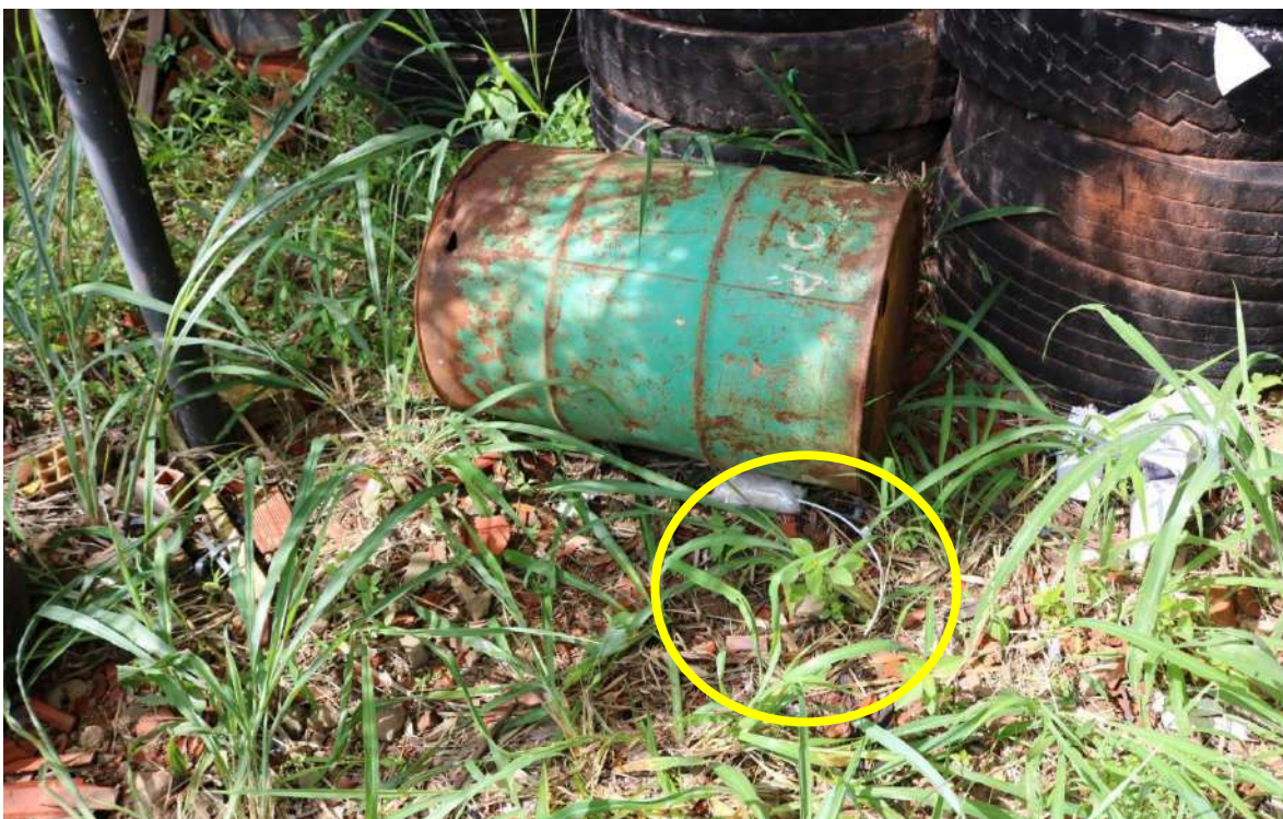
Fotografia 146 – Testes de campo. Em destaque, restante da emulsão explosiva do artefato examinado no Local 1, devidamente escorvada com espoleta nº 8 e estopim hidráulico.
