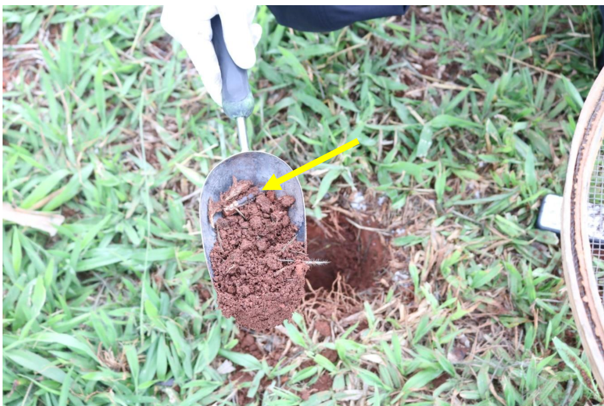
Fotografia 23 – Material retirado do interior da cova (região de neutralização do artefato). Seta indica pilha.
