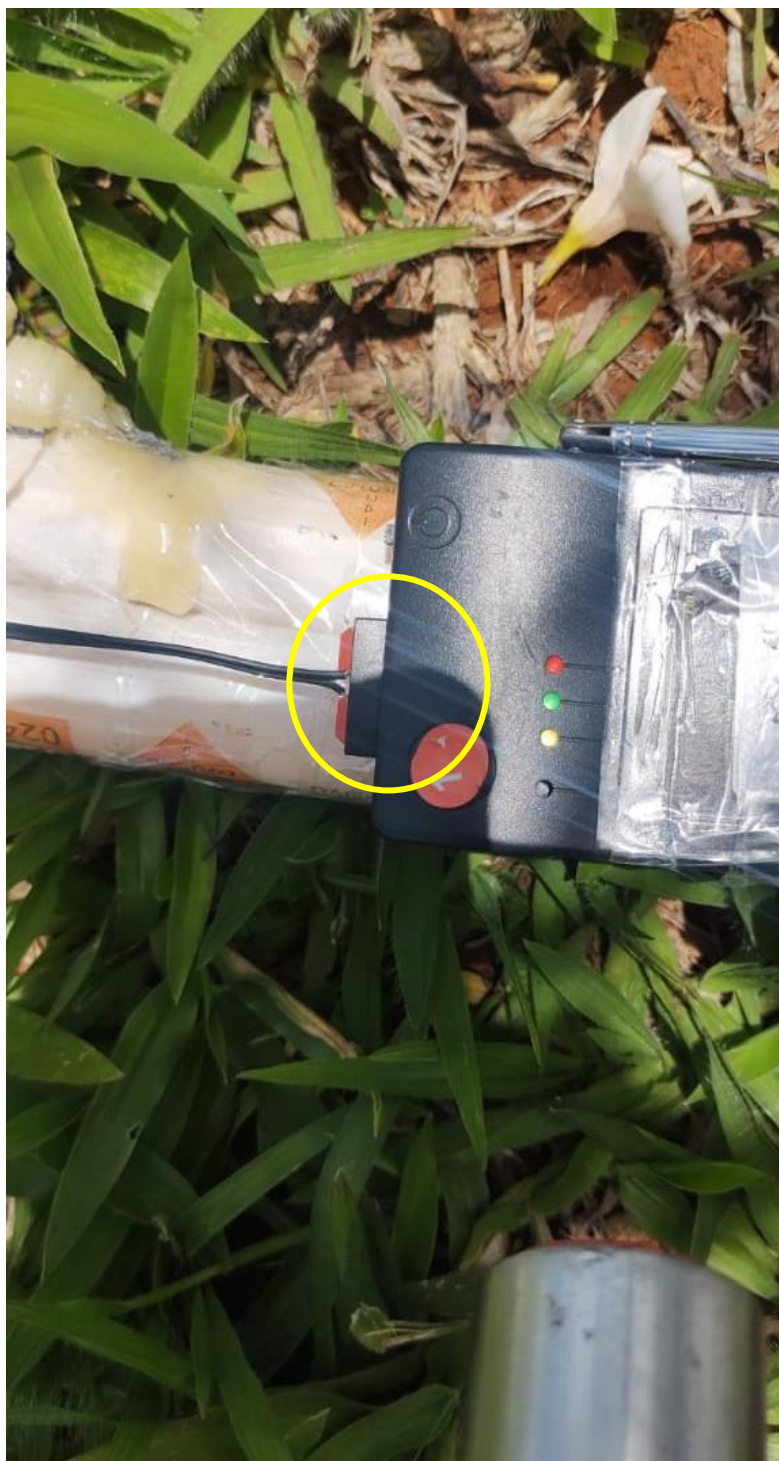
Fotografia 5 – Imagem do artefato antes da neutralização. Em detalhe receptor do eletrônico de radiofrequência. Em destaque, ponto de conexão dos feios metálicos do SKIB com o receptor. Imagem feita pelo operador do Esquadrão de Bombas da PMDF, que utilizava Traje Antibombas.
