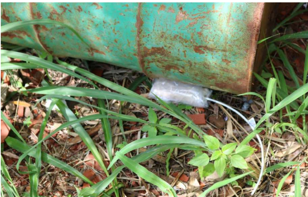
Fotografia 147 – Testes de campo. Em destaque, restante da emulsão explosiva do artefato examinado no Local 1, devidamente escorvada com espoleta nº 8 e estopim hidráulico.
