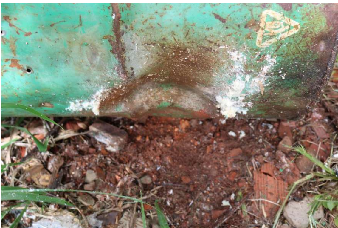
Fotografia 151 – Testes de campo. Região de pós explosão de uma das emulsões explosivas encartuchadas examinadas no Local 3.
