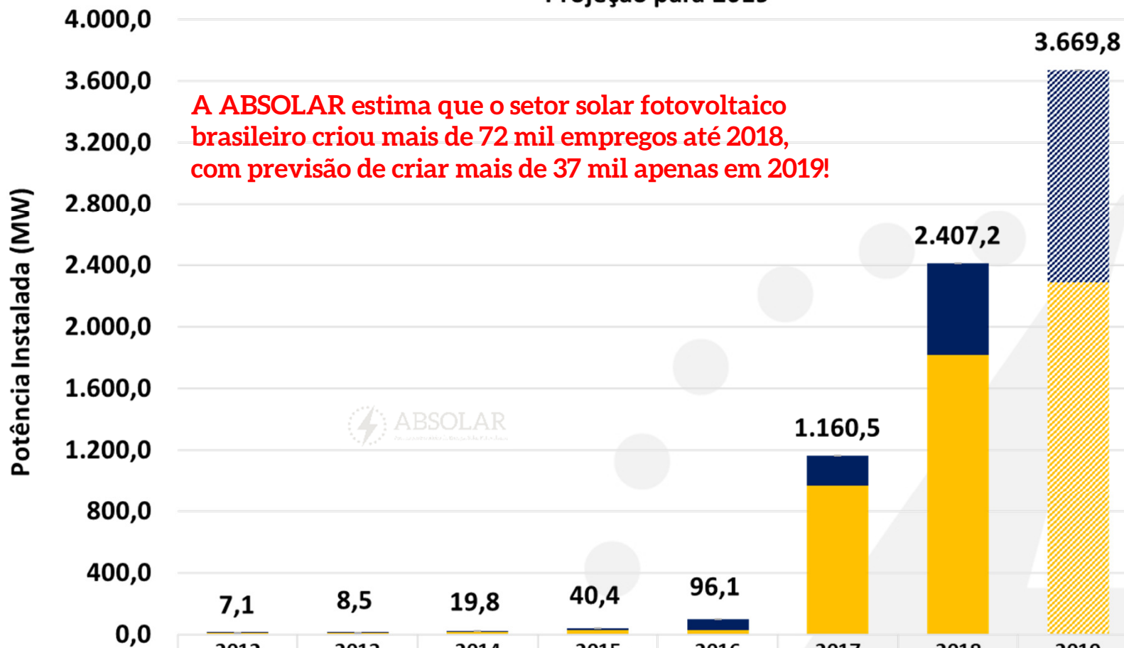
Potência Instalada Acumulada (MW) da Fonte Solar Fotovoltaica no Brasil e Projeção para 2019
