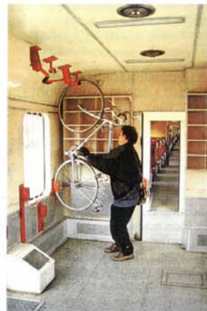
Adaptación del furgón de correos para el transporte de bicicletas en los trenes de cercanías de Renfe.
