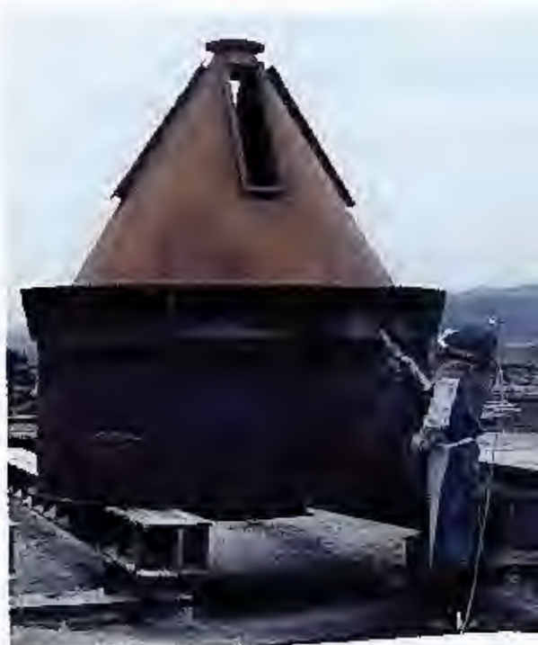
Jateamento: preparação da superfície a ser pintada
