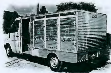
APREENSÃO DE ANIMAIS E CONTROLE DE ZOONOSES, COM COMPARTIMENTO VENTILADO E CABINE COM BANCOS PARA CAPTURADORES.
