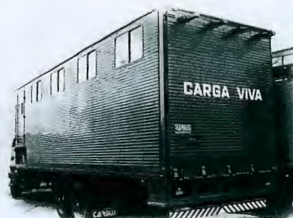
TRANSPORTE DE CAVALOS COM BAIAS FIXAS OU REMOVÍVEIS, TETO COM ISOLAMENTO TÉRMICO, PORTA TRASEIRA TIPO RAMPA.
