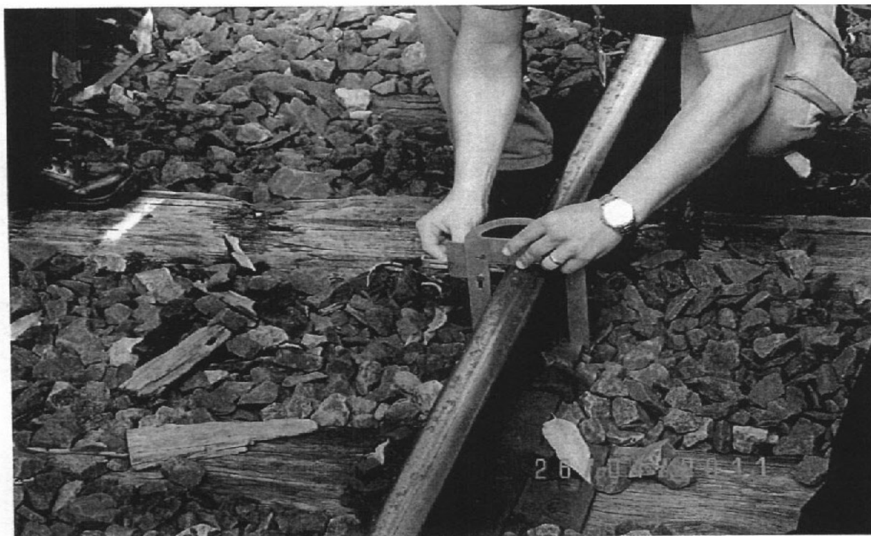
Foto 16: aparelho utilizado para medição de espessura de trilhos. Observar o dormente inservível marcado para substituição: reparo não providenciado (ALL Malha Oeste).
